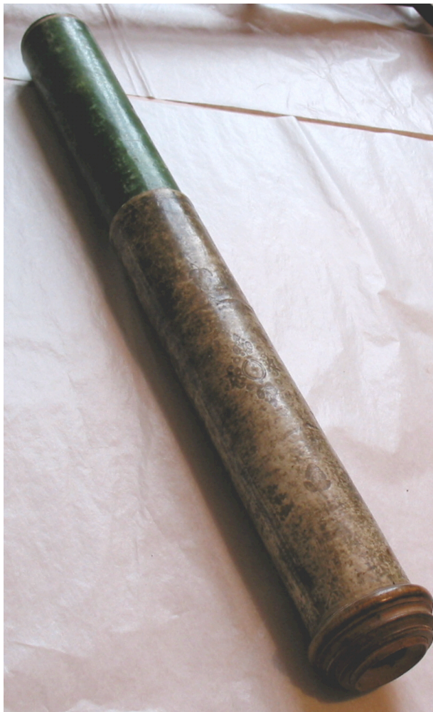
Kikare tillverkad cirka 1665 daterad genom jämförelse av pergamentsmönstret med en mönsterserie från London. Kikaren är komplett med originallinser, men har den svarvade ringen vid okularändan saknas.
