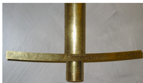
Nedre delen av Grahams sektor med 11 graders zenitdistansskala.
