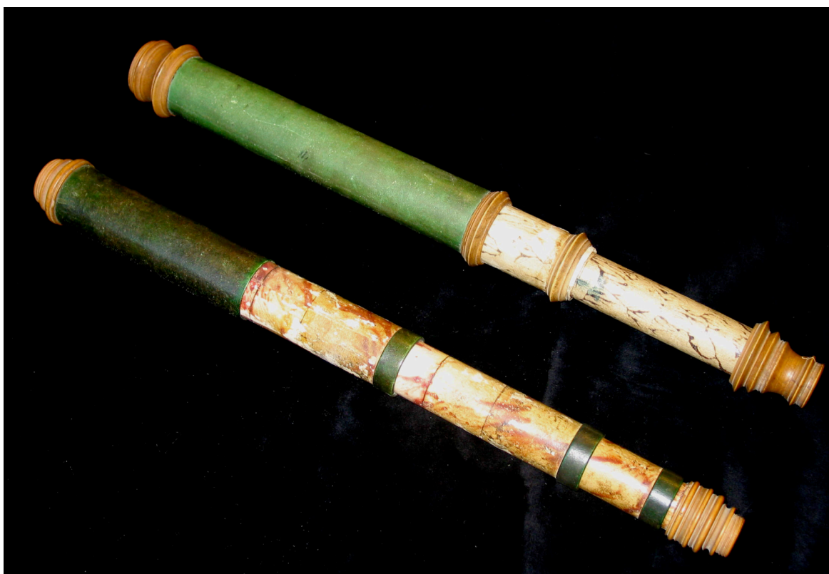
Två tubkikare av trä klädda med läder, troligen från omkring 1700.
