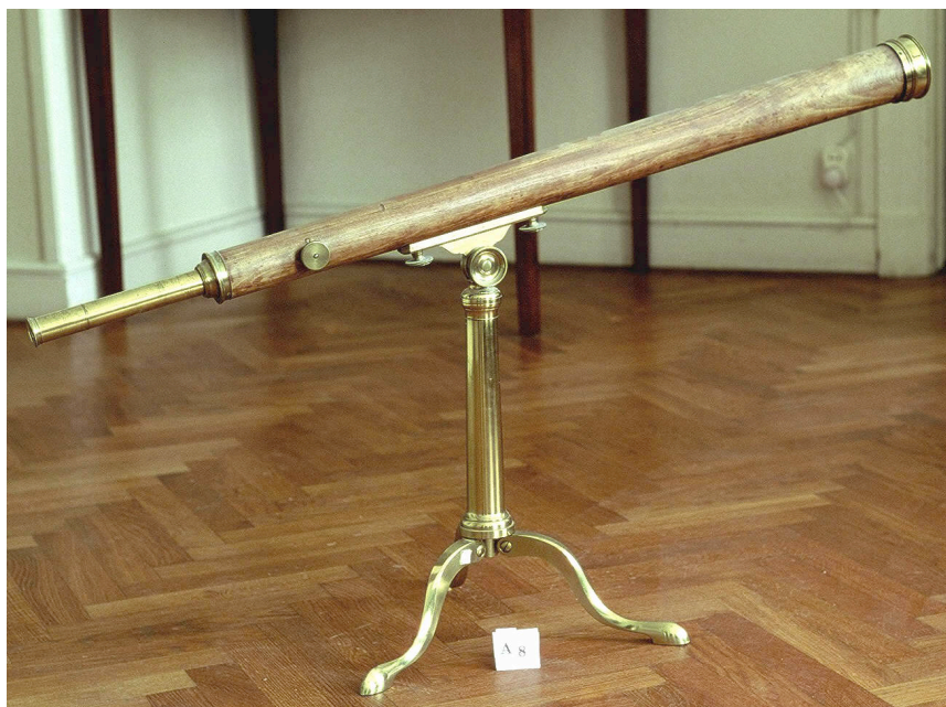
Akromatisk refraktor signerad Hellström Stockholm , skänkt av Johan Bredman 5/5 1832. Trätuben av mahogny har längden 90 cm och den totala längden är 108 cm. Objektivets diameter är 6.5 cm. Stativet är av mässing med låsbar höjd. Till refraktorn finns en transportlåda.
