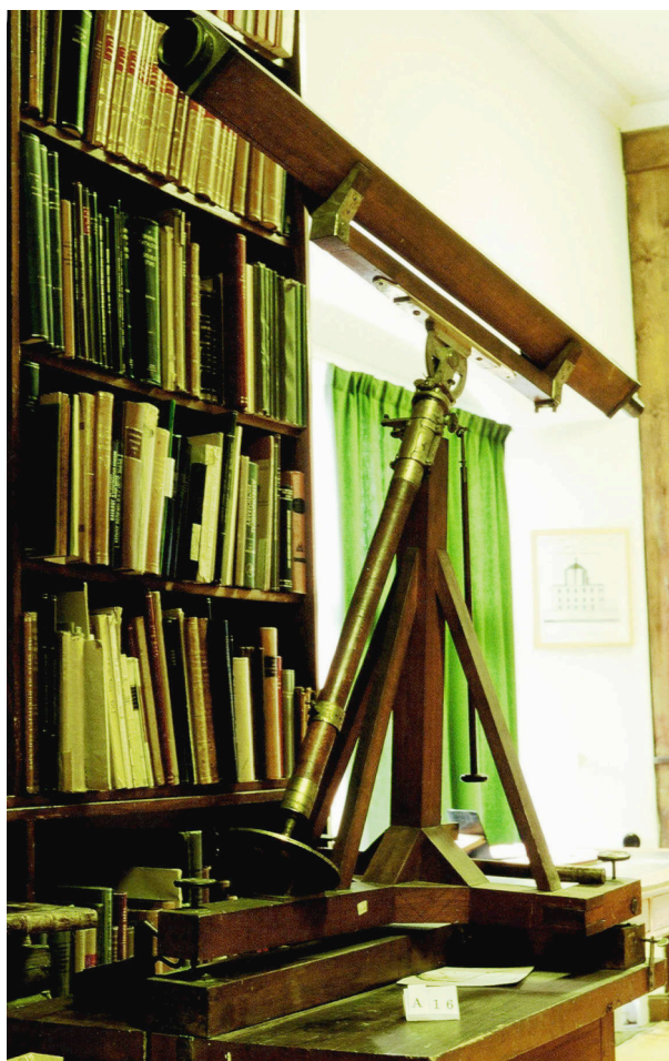
Ekvatoriell refraktor med kvadratisk trätub av längd cirka 144 cm.
