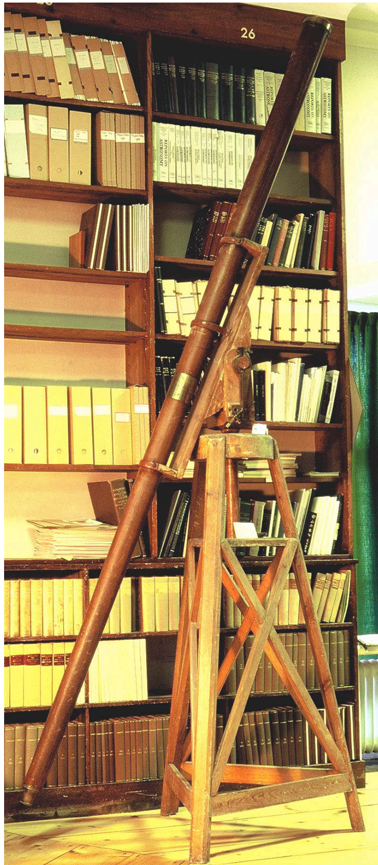
Azimutalt monterad refraktor med akromatiskt objektiv, tillverkad av Dolland, London.
