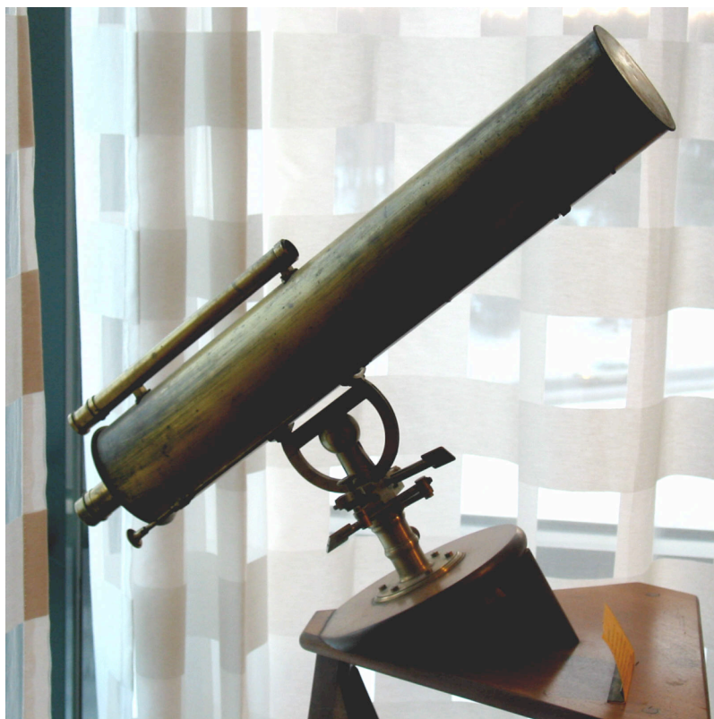
Spegelteleskop i mässing av James Short (1710-1768) tillverkat i London.
