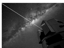
Laser guide star vid Very Large Telescope används för att korrigera för luftoro
