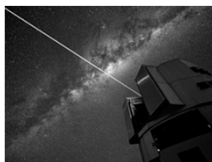
Laser guide star vid Very Large Telescope används för att korrigera för luftoro
